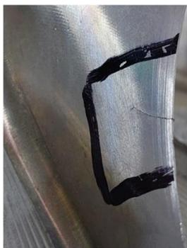
**Figure 1. Fracture on impeller blade (HAUS Turbo blower impeller)**
