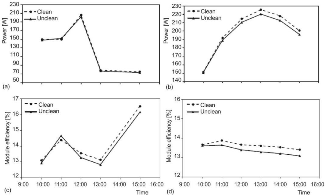
**Figure 6.** The PV system electrical power (a), (b) and module efficiency (c), (d) for cloudy (a), (c) and sunny (b), (d) days
